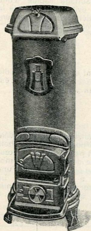
Ces calorifères sont formés d'un corps cylindrique en tôle, garni intérieurement de briques réfractaires, d'un chapiteau et d'un socle en fonte noire. Ils sont étudiés pour pouvoir brûler tous combustibles : anthracite, coke, charbon ou bois.
